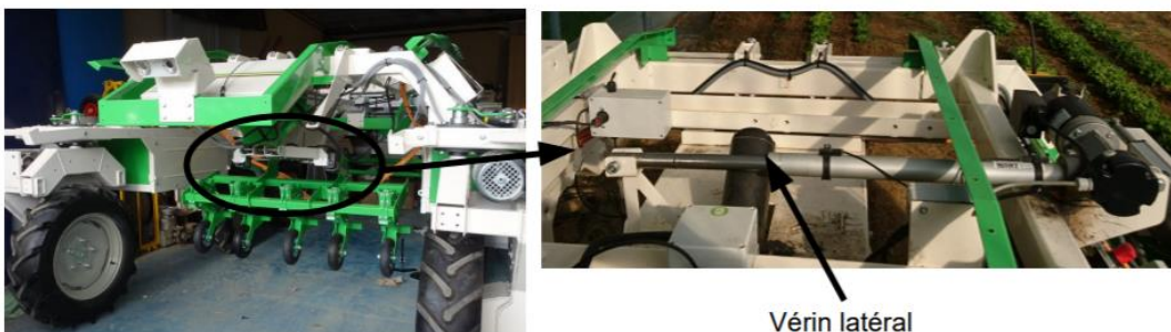
positionnement général et vérin électrique latéral
