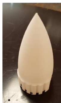
Etat de surface de meilleure qualité obtenu avec la Up Box (blanc) qu'avec la Da Vinci (vert) pour des pièces identiques et un réglage standard machine. Ps : ogive de fusée utilisées dans les projets de l'atelier scientifique et technique du collège.
