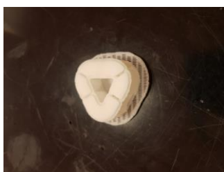
Accessoire de Smartphone – Impossible à imprimer sur la Da Vinci car mémoire insuffisante. Pas de pb sur la Up Box
