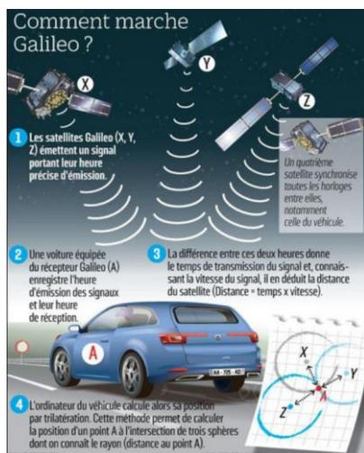
Le positionnement GPS fonctionne grâce au principe de **trilatération** ou la **triangulation**.
