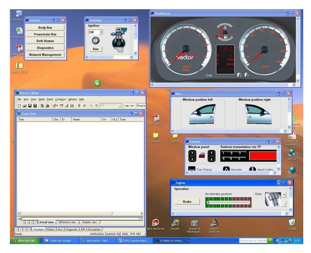
La simulation automot, permet de simuler une automobile dans laquelle on trouve 2 bus CAN (cf. schéma)
